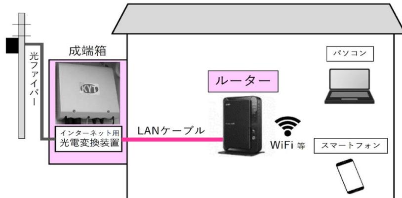
① 成端箱(光電変換装置)から伸びた LAN ケーブルをルーターの INTERNET ポートへ接続し
